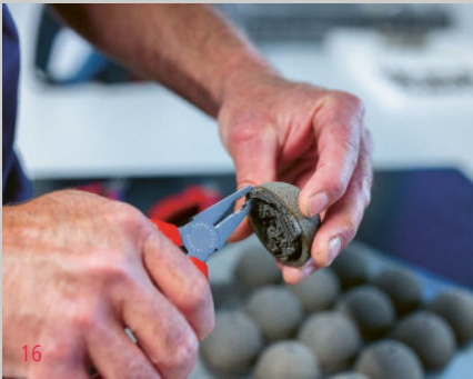
AUF DER ZIELGERADEN Gut erreichbare Stützstrukturen lassen sich nach Heimwerker-Art entfernen. Doch je nach Form des Implantats sind auch Maschinen nötig, etwa eine Fräse oder eine Drehbank, mit der sich heikle oder schwer zugängliche Bereiche präzise bearbeiten lassen.
