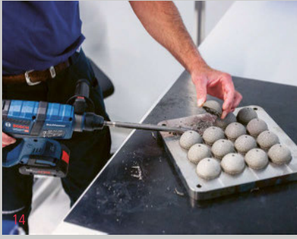
KRAFTVOLLE HANDARBEIT Erst jetzt trennt Patrick Stämpfli die Implantate von der Titanplatte, auf der sie der 3D-Drucker «festgebrannt» hatte.
