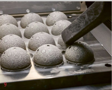
ABSAUGEN Im zweiten Schritt setzen die Fachleute einen speziellen Industriesauger ein.
