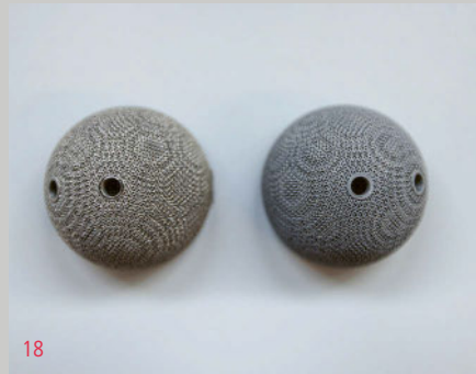
VORHER UND NACHHER Der Unterschied ist mit blossen Auge sichtbar. Gereinigt, sterilisiert und verpackt wäre das Implantat links nun bereit für die Verwendung als Hüftpfanne im OP.
