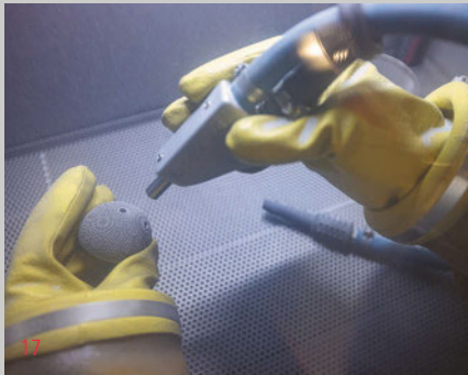
DER LETZTE SCHLIFF Patrick Stämpfli bearbeitet die Oberfläche – ähnlich wie beim Sandstrahlen. Hier schleifen allerdings feine Partikel aus Korund und dann aus Keramik das Implantat. Sie glätten es oder entfernen Verfärbungen durch das Glühen. Zudem verdichten die Keramikpartikel die Oberfläche ein wenig – ein Vorteil, wenn das Implantat noch beschichtet wird.
