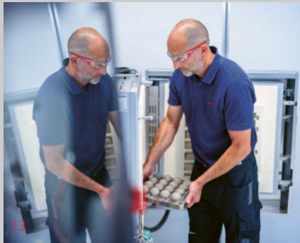
IM OFEN ENTSPANNEN Ein Fallstrick beim 3D-Druck ist die schichtweise Erhitzung. Während die oberste Schicht glutheiss ist, sind die unteren Schichten schon abgekühlt. Diese Unterschiede setzen das Material stark unter innere Spannung – und das sogenannte Spannungsarmglühen beseitigt sie: Die Implantate werden in diesem «Ofen» allmählich auf 600 bis zu 900 Grad erhitzt und kühlen dann langsam wieder aus.
