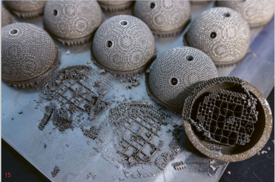
FILIGRANES TITAN Nun werden auch die Strukturen sichtbar, die den Halbkugeln beim Aufschichten die nötige Stabilität verliehen hatten: winzige Stützwände und -kanäle; gerade so viel Material wie unbedingt nötig.
