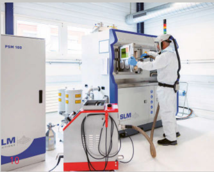
UND SICHER ENTSORGEN Er scheidet die Partikel in seinem Inneren in einem Wasserbad ab, damit nichts nach aussen dringen kann.
