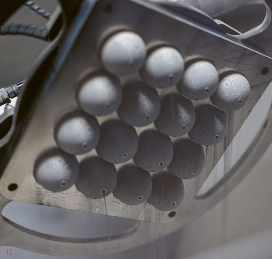
VIBRIEREN UND ROTIEREN Damit auch das letzte Körnchen hinausrieselt, dreht und wendet eine eigens installierte «Depowdering»-Maschine die gesamte Palette etwa eine Viertelstunde lang.
